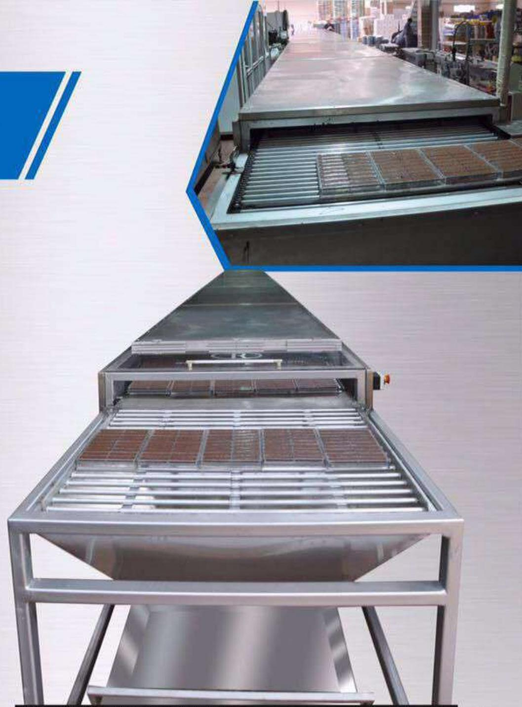
Soğutma kapasitesi / Cooling capacity : 23000 kcal / h
